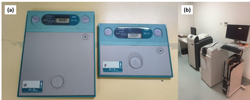
Gambar 2.4. Sistem reseptor computed radiography dengan (a) imaging plate dan (b) reader.
